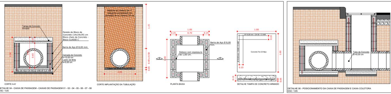
DETALHE 04 - CAIXA DE PASSAGEM - CAIXAS DE PASSAGEM 01 - 02 - 04 - 05 - 06 - 07 - 08
