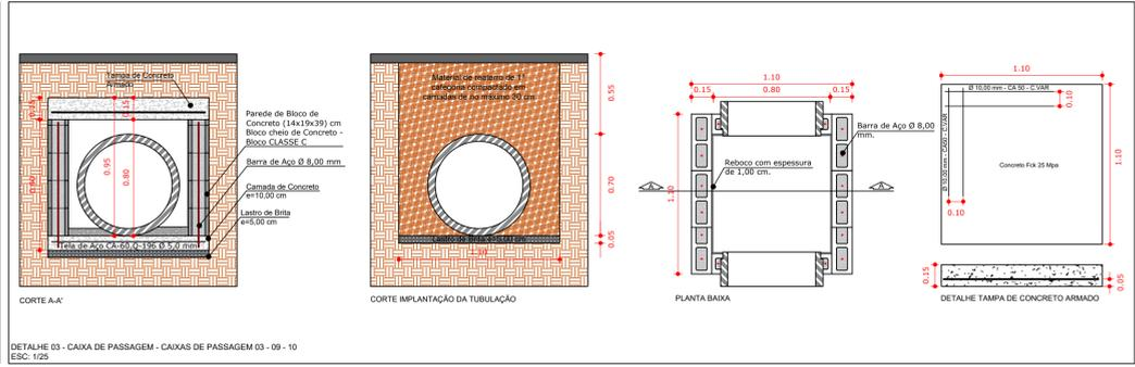
DETALHE 03 - CAIXA DE PASSAGEM - CAIXAS DE PASSAGEM 03 - 09 - 10
