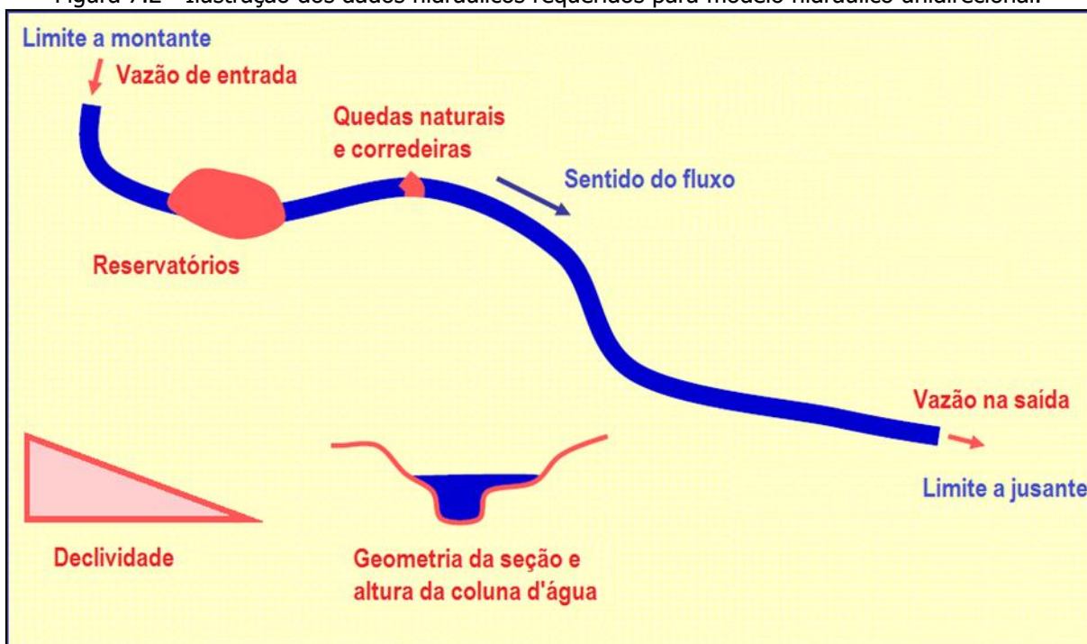
Figura 7.2 - Ilustração dos dados hidráulicos requeridos para modelo hidráulico unidirecional.
