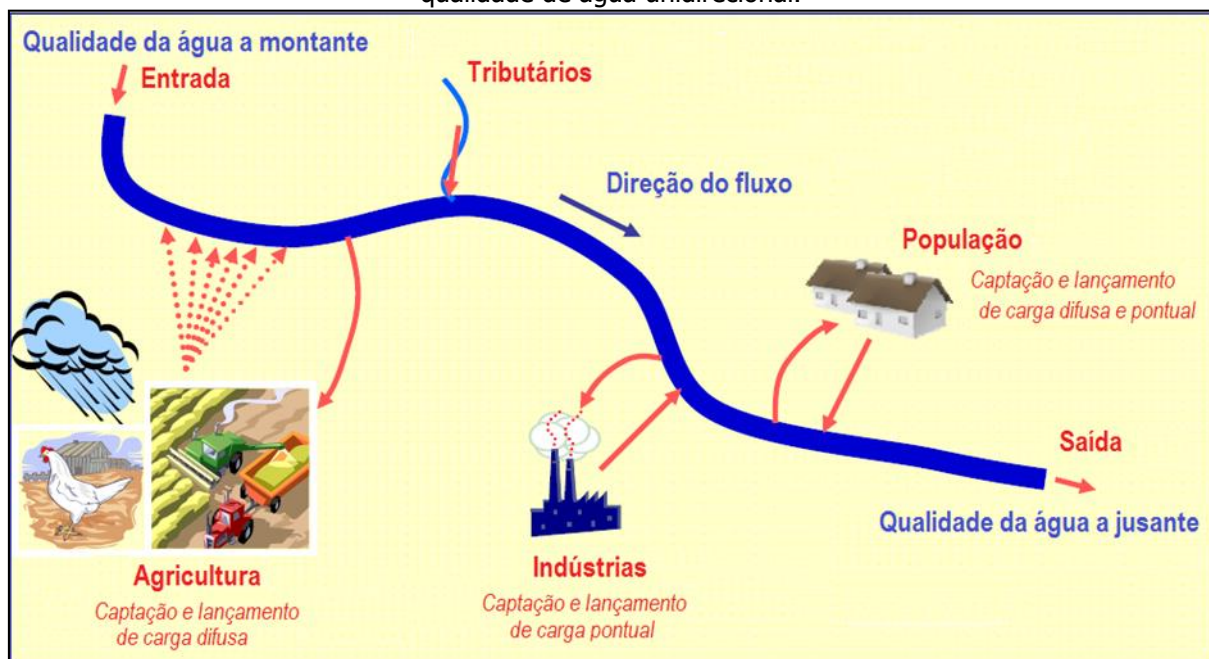
Figura 7.3 - Ilustração das captações e descargas de efluentes a serem simulados em modelos de qualidade de água unidirecional.
