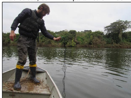
Figura 5.291 – Aferição das variáveis abióticas, com multiparâmetro AK88.
