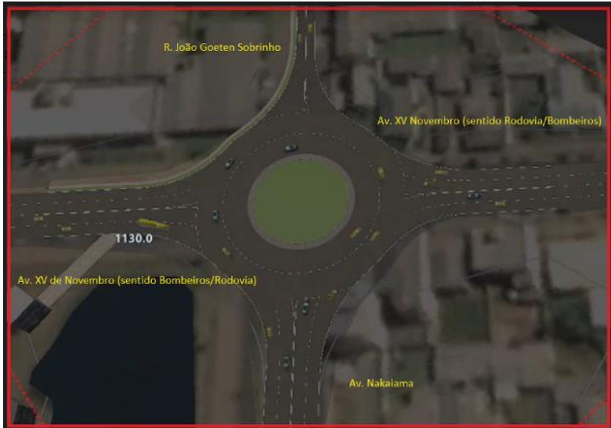
Figura 14 – Simulação de Tráfego Interseção Única - Situação Atual.
